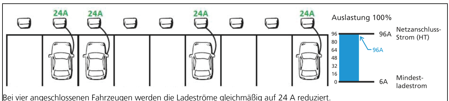
Abb. 11: Beispiel Lastmanagement Betriebszustand 2
