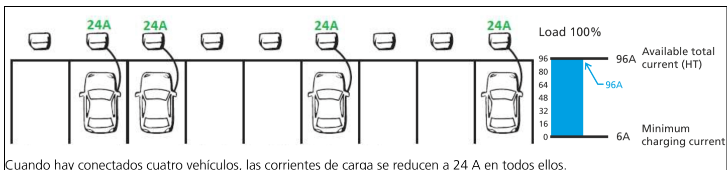
Fig. 11: Ejemplo de gestión de carga para el estado de servicio 2
